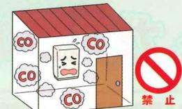
浴室内でCF式（自動破滅式）風呂釜を使用するときは換気扇を回さないでください。
